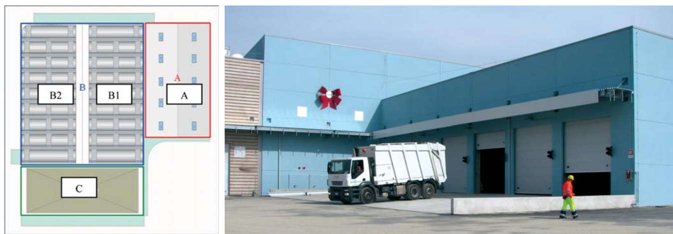
Figura 1 - Pianta della suddivisione in zone del fabbricato: A. zona di scarico, stoccaggio e pretrattamento; B.1 zona di biostabilizzazione; B.2 zona di raffinazione e produzione cdr; C. zona di pressatura e stoccaggio del materiale finito. A destra un autocarro nella zona d'ingresso.
